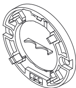
Plaque de fixation avec niveau intégré
