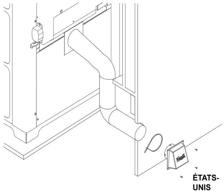
Figure 16.2 - Installation au sol
