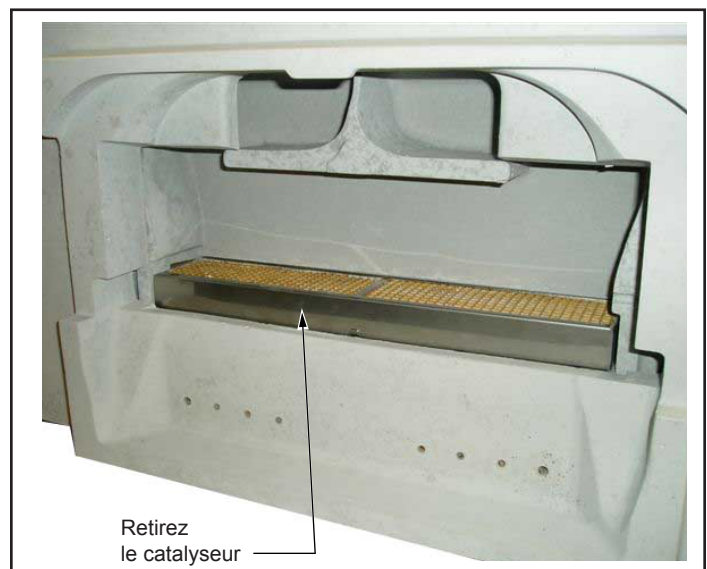
Figure 3.12 – Retrait du catalyseur.
