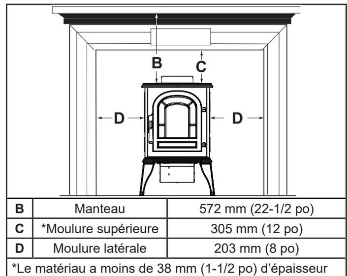
Figure 3.11 – Dégagements avec le manteau et les moulures.
