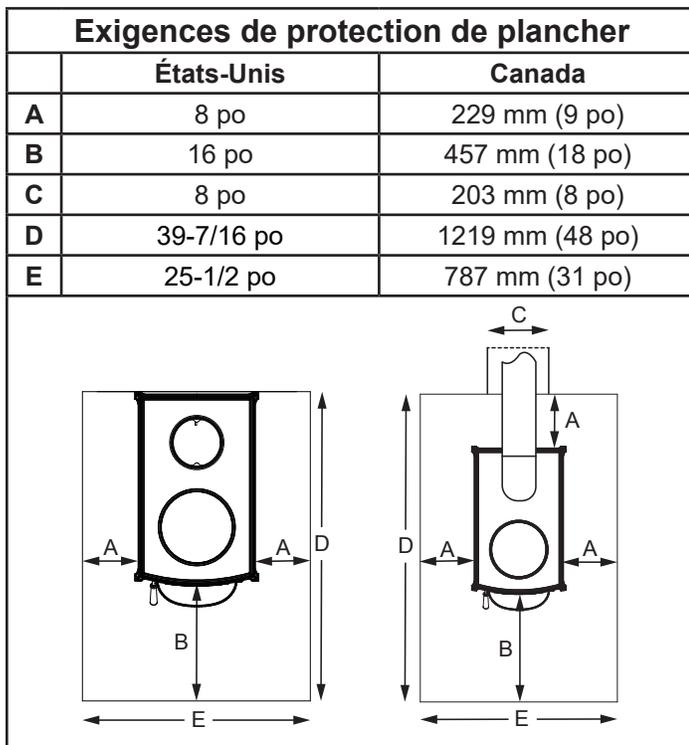
**Figure 3.4** – Ces dimensions ne sont que des exigences minimales. Utilisez des dimensions plus grandes chaque fois que possible.
