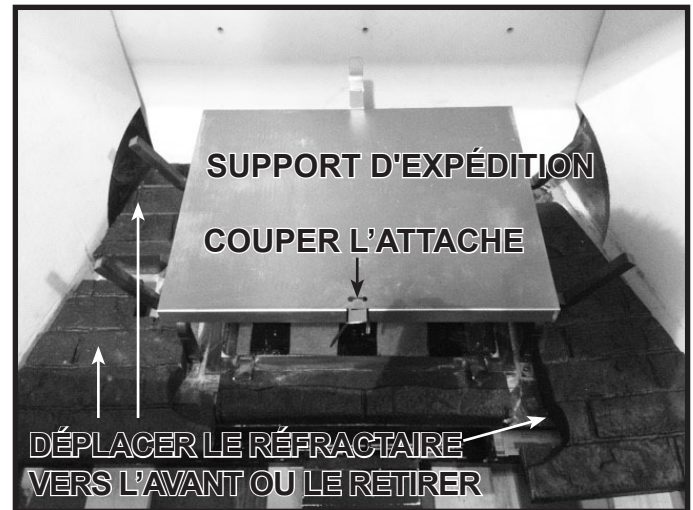
Figure 11.10 Détacher le support d'expédition de la grille de bûche
