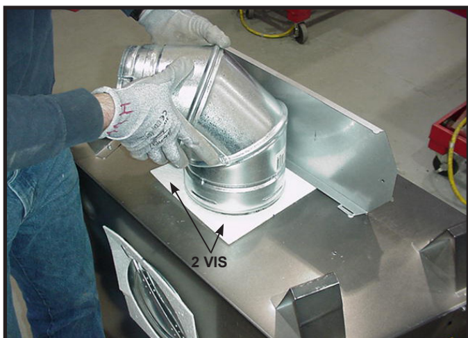
Figure 6.11 Pour fixer la première section du conduit d'évacuation, assurez-vous d'utiliser le joint d'étanchéité en fibre de verre pour sceller entre le premier composant et l'enveloppe extérieure du foyer. Utilisez 2 vis autotaraudeuses pour fixer le joint d'étanchéité à l'enveloppe extérieure.
