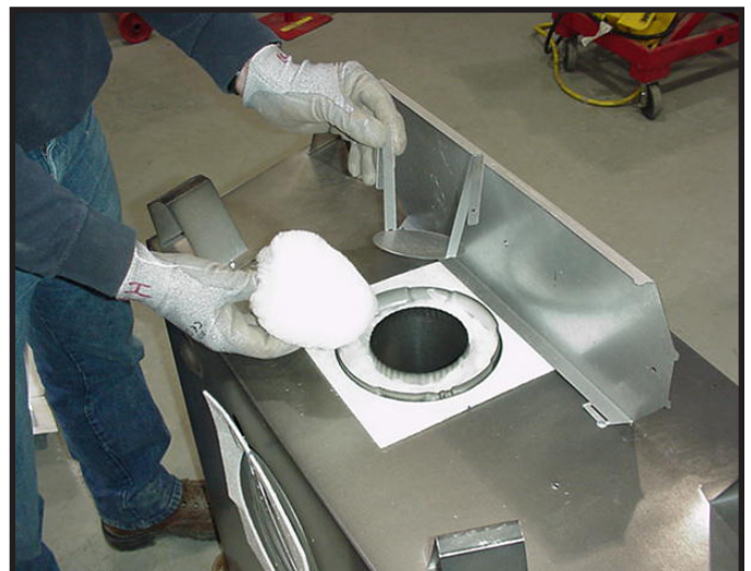
Figure 6.9 Retirez le panier d'isolation et l'isolant blanc du centre du conduit d'évacuation des gaz.
