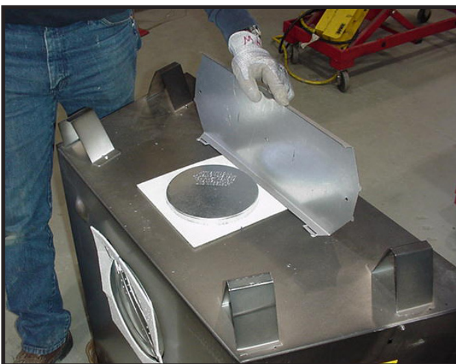
Figure 6.6 Faites tourner l'écran thermique supérieur en position verticale, comme il est indiqué ci-dessus. L'écran thermique doit demeurer en position verticale.
