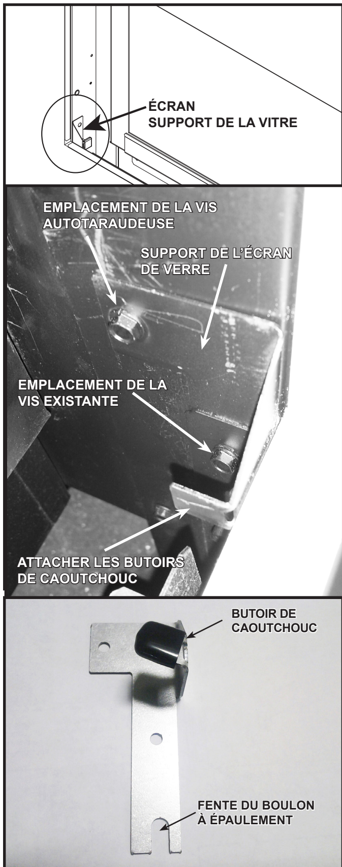
Figure 10.12 Installer les supports de l'écran de verre
