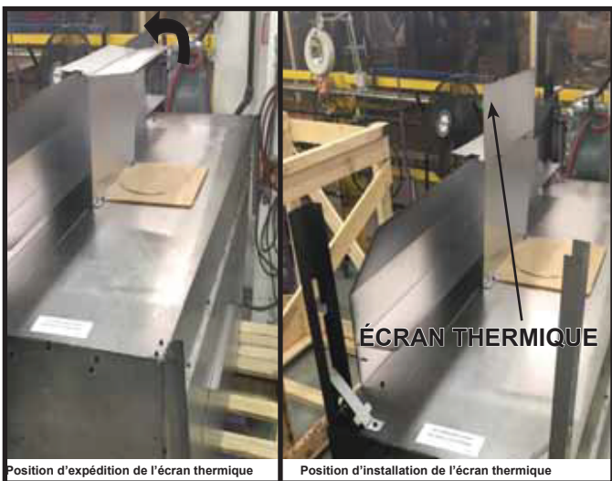
Figure 6.2 Écran thermique montré une fois installé
