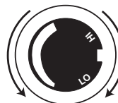
Fig. 56 Bouton de réglage des flammes pour le distributeur SIT.
